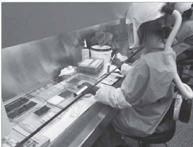
Рис. 1. Нанесение SARS-CoV-2 на материалы в шкафу биобезопасности
